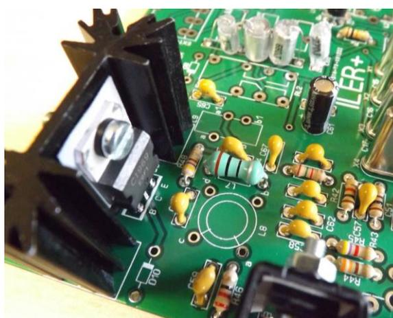
Si usted tiene previsto trabajar a máxima potencia y durante largos periodos de tiempo (en estación base) puede ser recomendable aumentar la superficie de refrigeración. Usted puede añadir algún sistema para aumentar la disipación de temperatura, por ejemplo mediante una superficie metálica auxiliar, un mini-ventilador u otro sistema similar.
