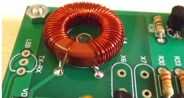
La frecuencia de la FI 4.915MHz se resta a la del VXO, por ejemplo 12.010MHz para obtener la de frecuencia de trabajo 7.095MHz. Otro ejemplo podría ser FI 4.915 y VXO 12.065MHz = 7.150MHz.
