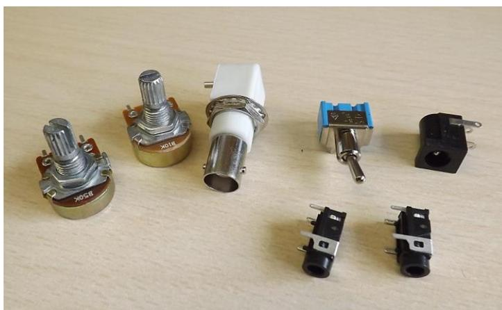
Antes de colocar los zócalos Jack, debe cortar las protuberancias situadas en la parte de abajo. De lo contrario no podrá soldar sus terminales correctamente. Vea la imagen.
