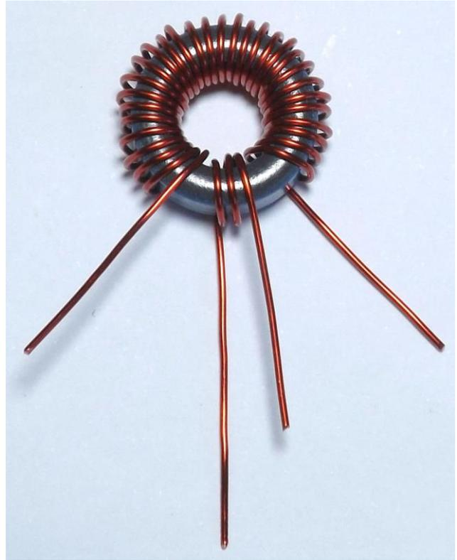
Rasque con un “cutter” o similar el trozo de hilo para que pueda soldarlo en la placa.
