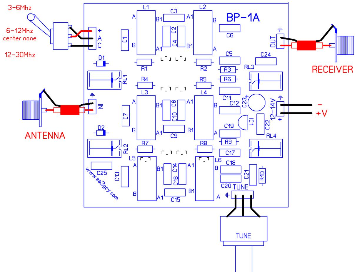
La entrada de antena se realiza a través de los terminales marcados "IN" y la salida hacia el receptor a través de los terminales "OUT" (use cable coaxial de 50ohms para ambas conexiones)
