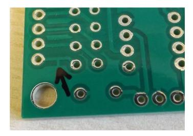
Si usted desea usar el potenciómetro de ajuste de velocidad, deberá conectar un potenciómetro de 10K en el terminal "S" y **DEBERÁ CORTAR** la pista del circuito impreso que conecta el pin con GND.
